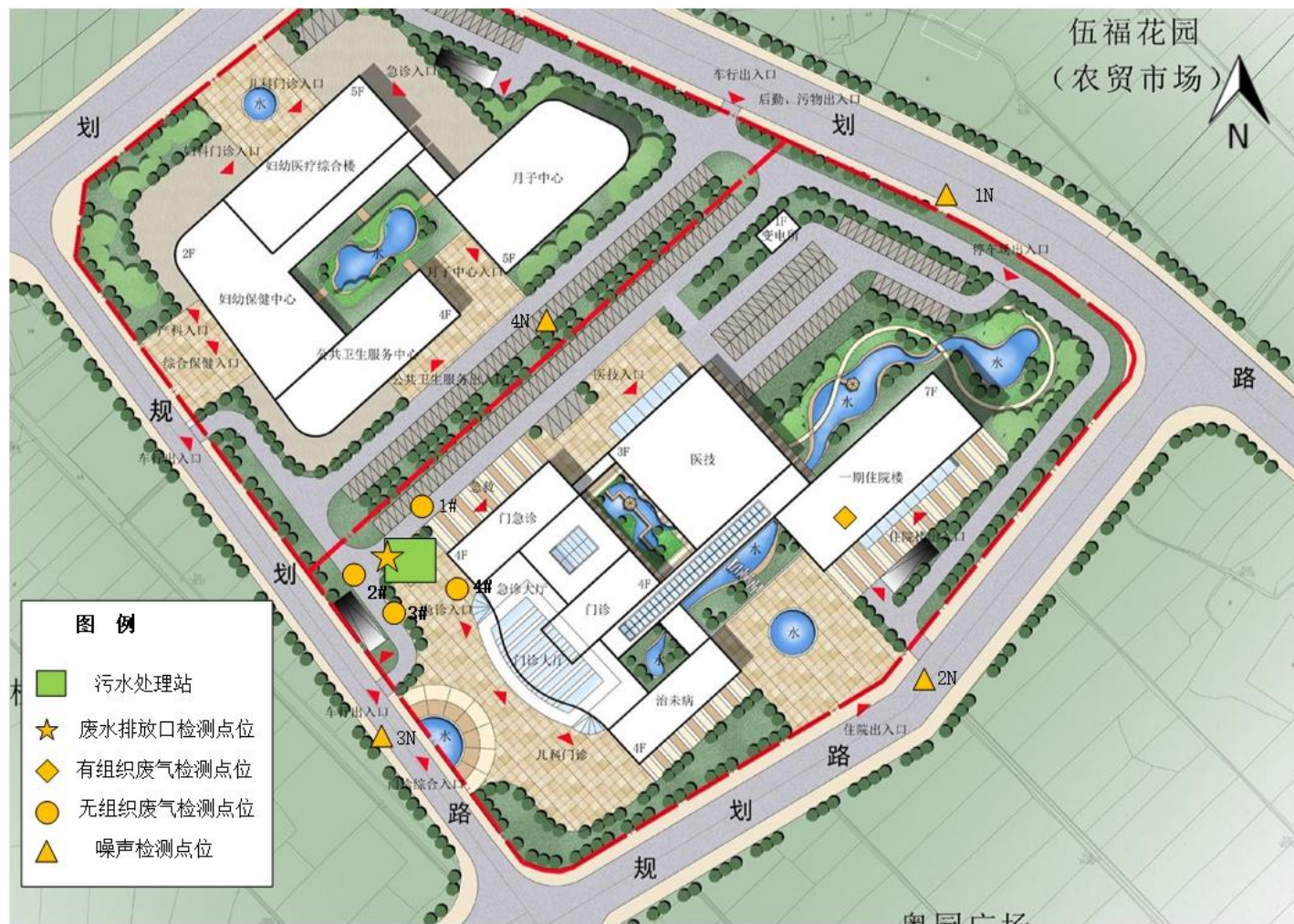
图 7-1 废水、废气（有组织）及噪声监测点位布置图
