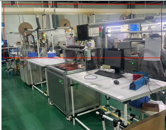
电子传感器半自动生产线废气收集措施
