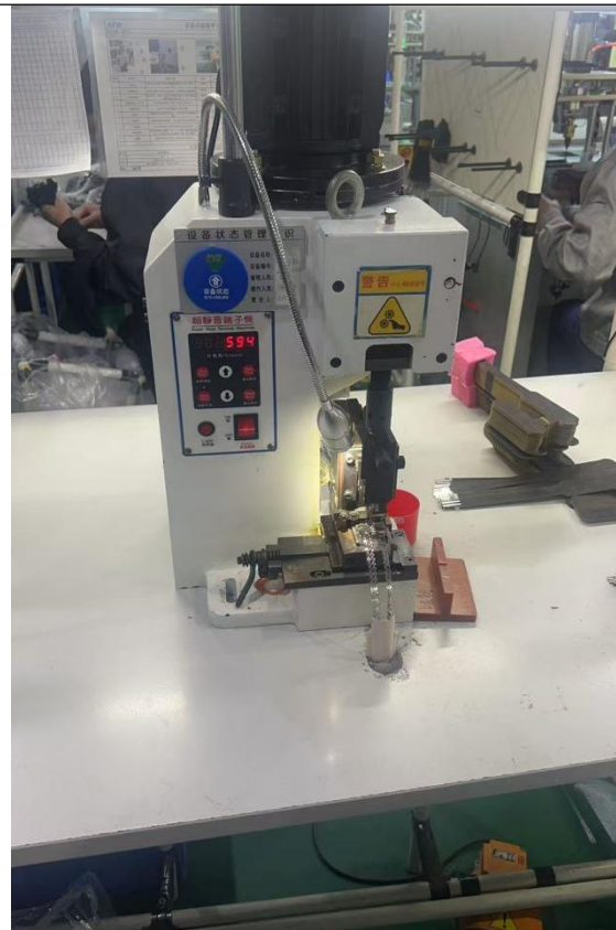
压接端子机+焊接
